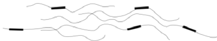
圖 62、聚合物材料之應變軟化示意圖
