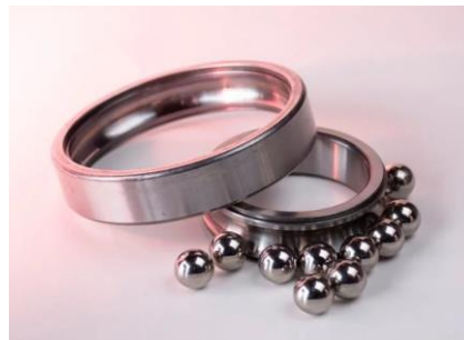
圖 34、(a)建築廣泛使用之低碳鋼；(b)用於軸承之高碳鋼 (找尋免費開源素材)
